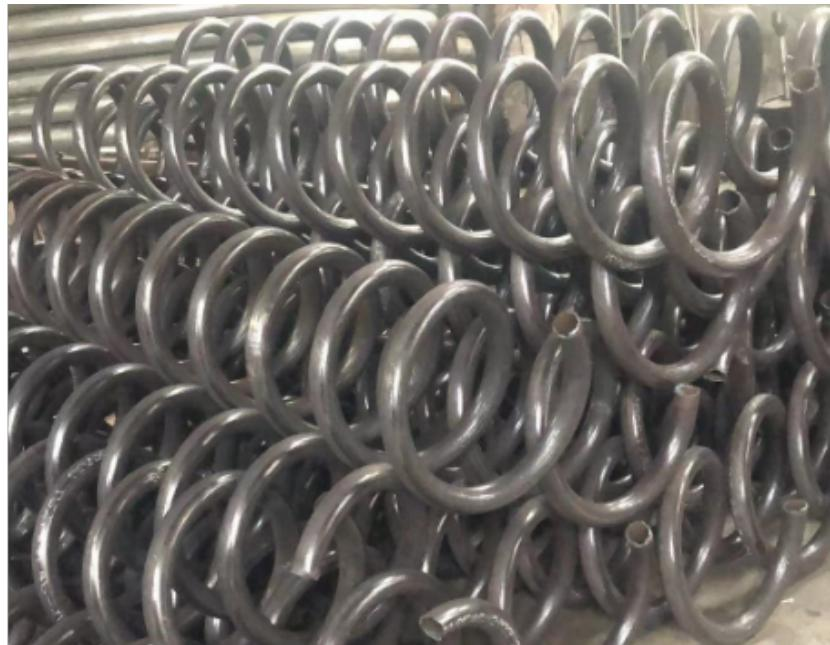
对于市场中的半管，往往是需要了解清楚它们的本质才能够使用它们的。下面小编就来给大家分享分享，在半管本质当中所存在的优越性。1. 使用半管的时候，它自身工作时进行的传热效果可以说是非常优越的。2. 当制作半管时夹套面积较小的时候，其中介质在流动的速度就会越快，在增加半管壁厚时，该款半管的性能也会破坏掉变为塑性的变形。半圆管在打磨抛光时，一般有以下几点是要多加留意的。1. 历经经深拉伸的产品，在形变量很大的地区表层会出小的小黑点，从而影响到打磨抛光性。2. 注意材料要素。要是强度过低，打磨抛光时抛亮这一步就较为艰难，也有强度太低，在深拉伸时表层易出现橘皮状况，影响打磨抛光性，对强度高的材料而言，其打磨抛光性相对性要好些。3. 留意半圆管原材料表层存有的一些缺点，如刮伤、黑点、过酸洗钝化等。
